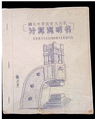
这是《500吨单臂锻造水压机计算说明书》，为杨红鹰校友所捐赠。该《计算说明书》是第一重机厂“500吨单臂锻造水压机”设计项目的重要组成部分，也是东重锻压七四一班第一小组的本科毕业设计作品。该项目组遵循学以致用、教学与实践相结合的原则，充分调研、精心设计，在潘景生老师的指导下，于1977年3月至9月完成设计，全部图纸均为手工绘制。针对设备主体结构强度及刚度进行了精确计算，并对设备操控功能及液压系统给与优化设计及说明。这本在锻压七四人手中珍藏了四十余年的《计算说明书》成为学校重视“学、研、产互动”的真实成果与典型案例，值得我们学习和借鉴。
