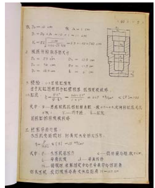
这是《500吨单臂锻造水压机计算说明书》，为杨红鹰校友所捐赠。该《计算说明书》是第一重机厂“500吨单臂锻造水压机”设计项目的重要组成部分，也是东重锻压七四一班第一小组的本科毕业设计作品。该项目组遵循学以致用、教学与实践相结合的原则，充分调研、精心设计，在潘景生老师的指导下，于1977年3月至9月完成设计，全部图纸均为手工绘制。针对设备主体结构强度及刚度进行了精确计算，并对设备操控功能及液压系统给与优化设计及说明。这本在锻压七四人手中珍藏了四十余年的《计算说明书》成为学校重视“学、研、产互动”的真实成果与典型案例，值得我们学习和借鉴。
